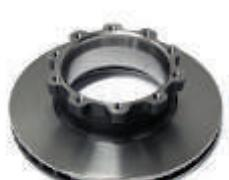
ДИСК ТОРМОЗНОЙ АВТОМОБИЛЯ
